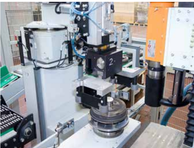
Equilibratura di tamburi auto Car drum balancing
