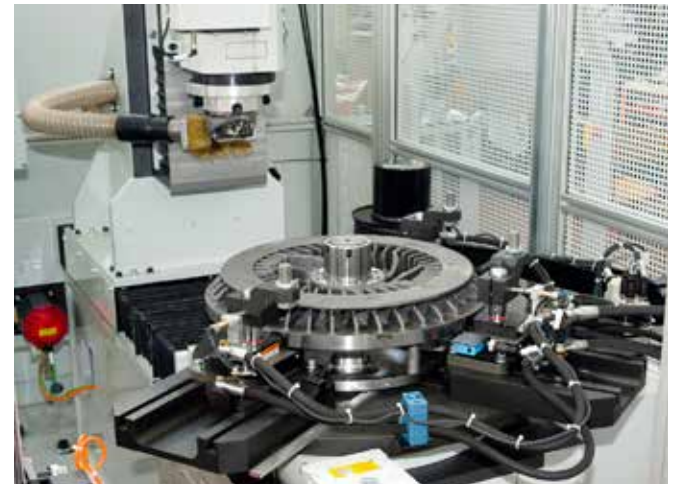
Equilibratrice a due piani di correzione per dischi freno elettrici Electrical brake disc two planes balancing machines
