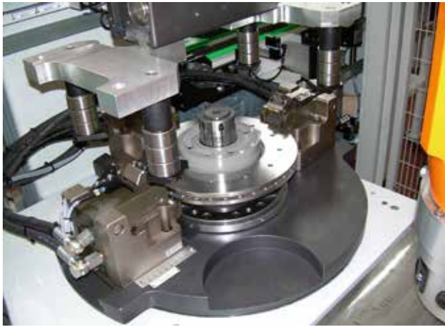
Dettaglio di mano di presa caricatore e staffaggi Detail of the loader picking gripper and clampings
