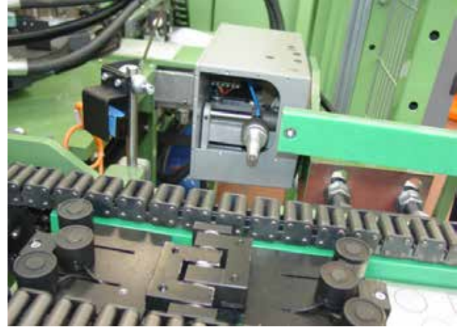
Marcatore a micropunti su trasportatore in uscita Micropoints marker placed on the output conveyor
